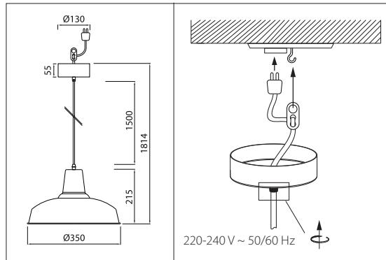
Käytä ainoastaan valonlähettää ja tehoa jo-ka valaisimeen on merkity. Kytke virta pois päältä ennen asennusta tai huoltoa. Liitäänt-johto ei voi vaihtaa eikä korjata. Mikäli johto vaurioituu, on valaisin hävitettävä ja toimitettava asianmukaisesti kierätyspisteesseen. Tämä asennusohje on säälytettävä ja sen on oltava käytössä asennuksessa ja huollossa.
