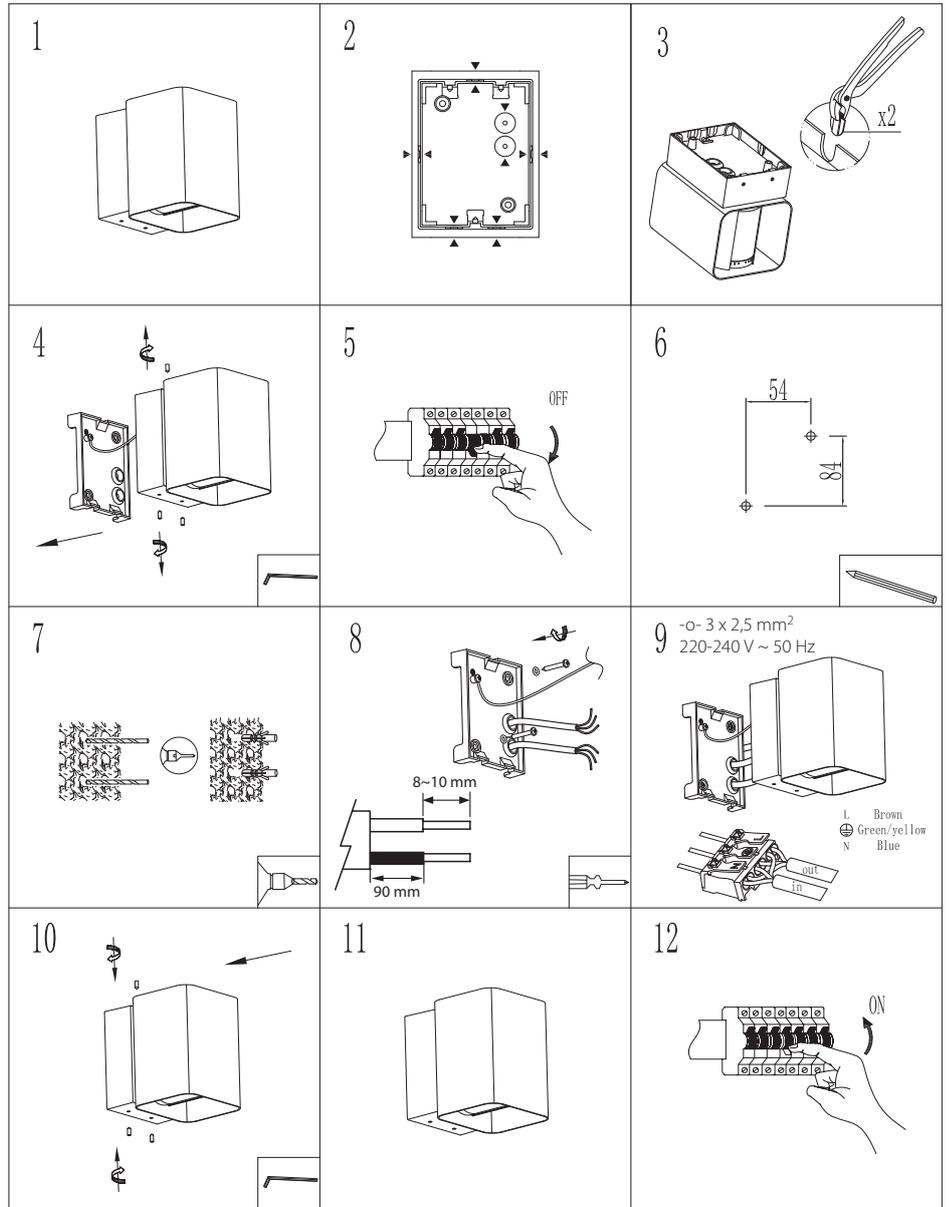
Valaisimen saa asentaa vain sähköalan ammattilainen. Käytä ainoastaan syöttöjännitettä ja taajuutta joka on merkitty valaisimeen/liitäntälaitteeseen. Kytke virta pois päältä ennen asennusta tai huoltoa. Tämä asennusohje on säilytettävä ja sen on oltava käytössä asennuksessa ja huollossa. Valaisimen valonlähde ei ole käyttäjän vaihdettavissa. Vaihda tilalle uusi valaisin, jos valonlähde rikkoutuu (⚠). Huolehdi valaisimen osien asianmukaisesta kierrätyksestä.
