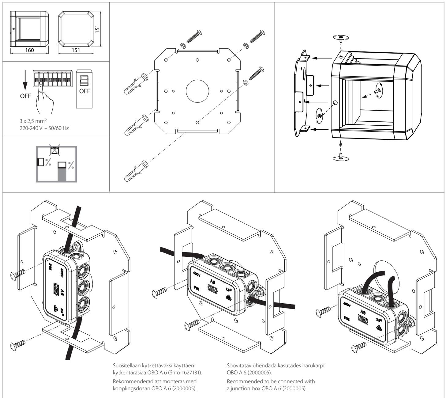
Valaisimen saa asentaa vain sähköalan ammattilainen. Käytä ainoastaan syöttöjännitettä ja taajuutta joka on merkitty valaisimeen/liitäntälaitteeseen. Kytke virta pois päältä ennen asennusta tai huoltoa. Tämä asennusohje on säilytettävä ja sen on oltava käytössä asennuksessa ja huollossa. Valaisimen valonlähde ei ole käyttäjän vaihdettavissa. Vaihda tilalle uusi valaisin, jos valonlähde rikkoutuu.
